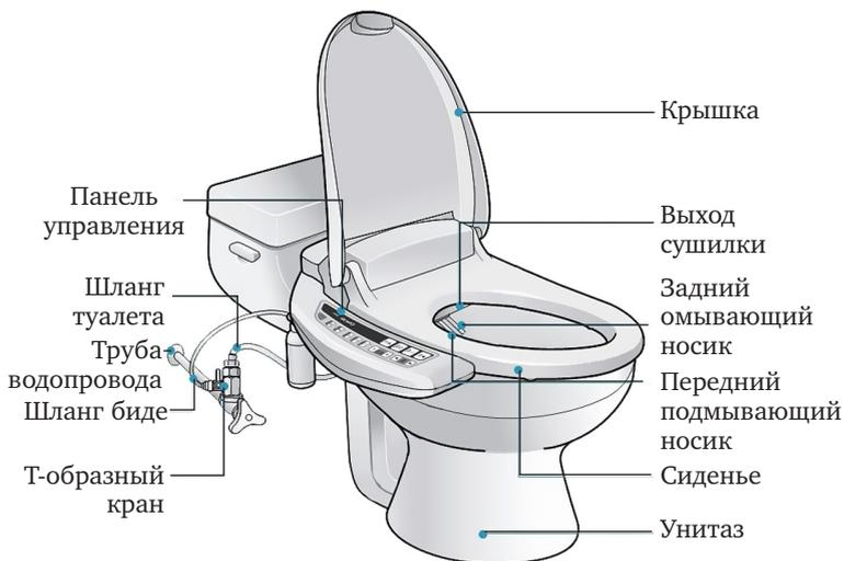
Рис. 2.33. Конструкция унитаза
