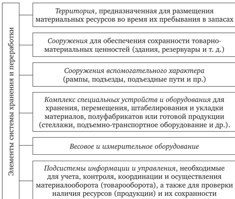
**Рис. 1.2. Элементы системы хранения и переработки**
