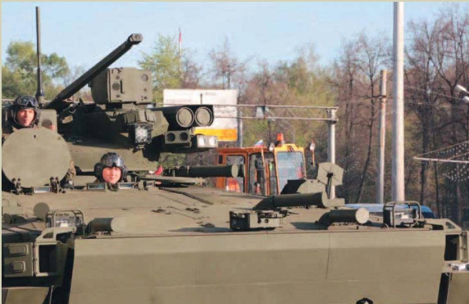
На предсерийном образце БМП К-11 для членов экипажа оборудованы два люка в зоне отделения управления
