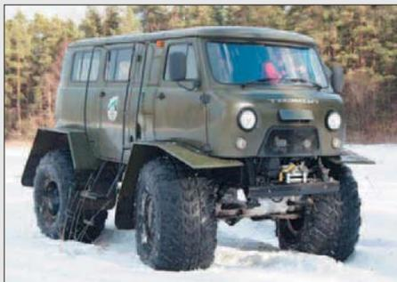
Научно-производственная фирма «Трэкол» представила новый грузопассажирский вездеход ТРЭКОЛ ТРОФИ на базе УАЗ-452, сообщает издание EX-ROADmedia. Машина с расположением двигателя за передней осью и цельнометаллическим кузовом изготовлена на базе стандартных комплектующих российских автопроизводителей.
