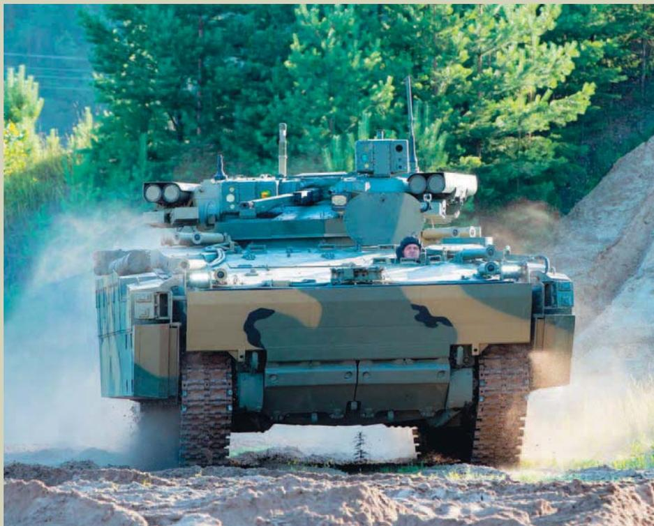
*Опытный образец БМП на платформе «Курганец-25» с тремя люками для членов экипажа*
